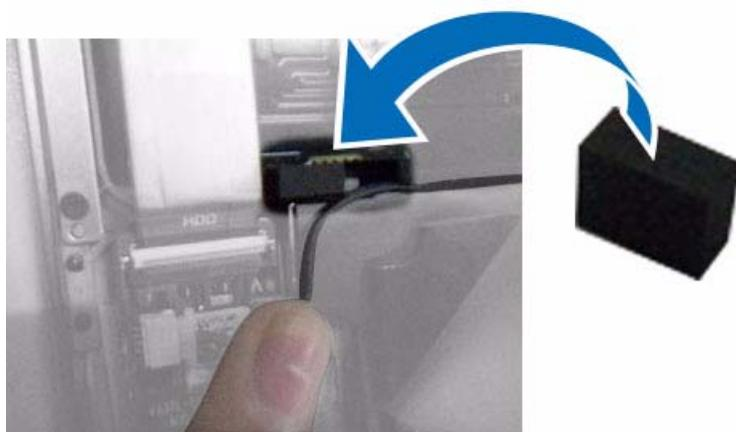
6 Recoloque o cabo após colocar o protetor de borracha.
