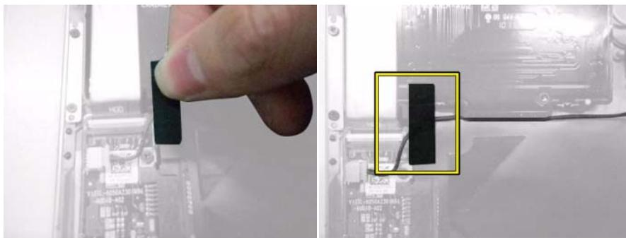
8 Retire delicadamente a fita dupla-face do cabo flexível do disco rígido de substituição.
