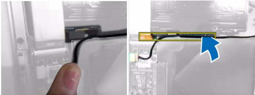
7 Fixe a fita de dupla face sobre o cabo e o protetor de borracha para assegurar que o cabo está preso.
